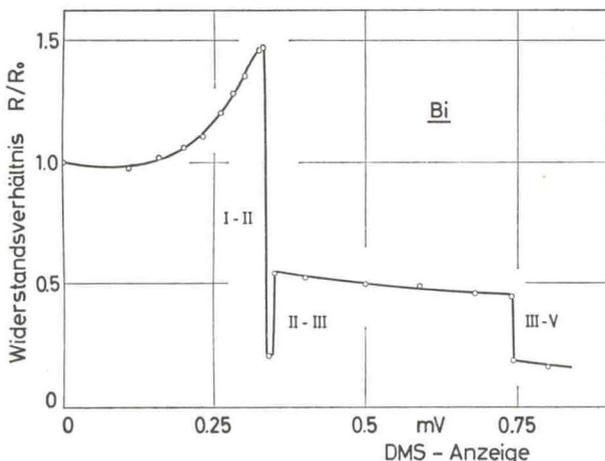
Abb. 4. Widerstandsverlauf von Wismut über der Pressenkraft
