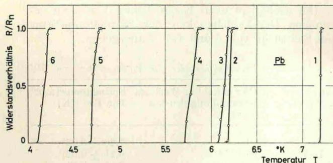
Abb. 6. Die zu den Meßpunkten in Abb. 5 gehörenden Sprungkurven von Blei (vgl. Tab. 2): Kurve 2  $p = 25,4$  kbar, 3  $p = 27$  kbar, 4  $p = 37$  kbar, 5  $p = 78$  kbar, 6  $p = 107$  kbar, 1 nach Entlasten auf  $p = 0$
